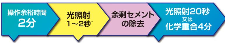
ミキシングチップから押し出し後の操作余裕時間 余剰セメントの半硬化時間
