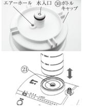
水位が最低レベルまで少なくなった場合は水が出ない恐れがあります。常にボトルの中に 十分な洗浄液があることを確認して下さい。洗浄液なしで使用するとチップの先端がすぐに 発熱します。ボトルの中に入れる洗浄液の温度は35℃を超えないようにして下さい。 火傷するおそれがあります。
